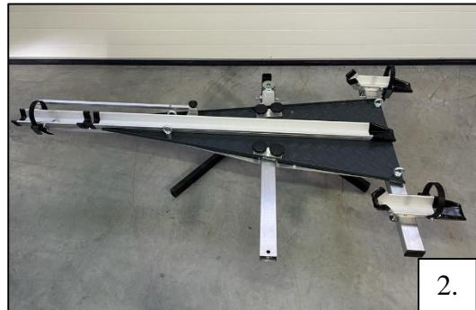
2 Schieben Sie die Dreiradtrageeinheit auf das montierte Aufschubrohr.
