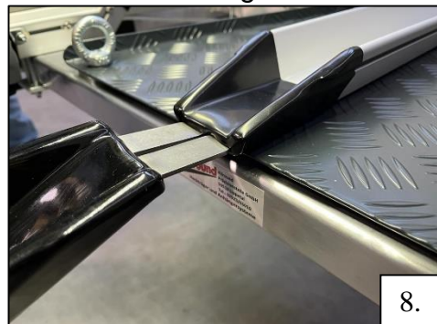
8 Die Auffahrschienen können mittels der Zungen in die Kufen und Standschiene gesteckt werden.
